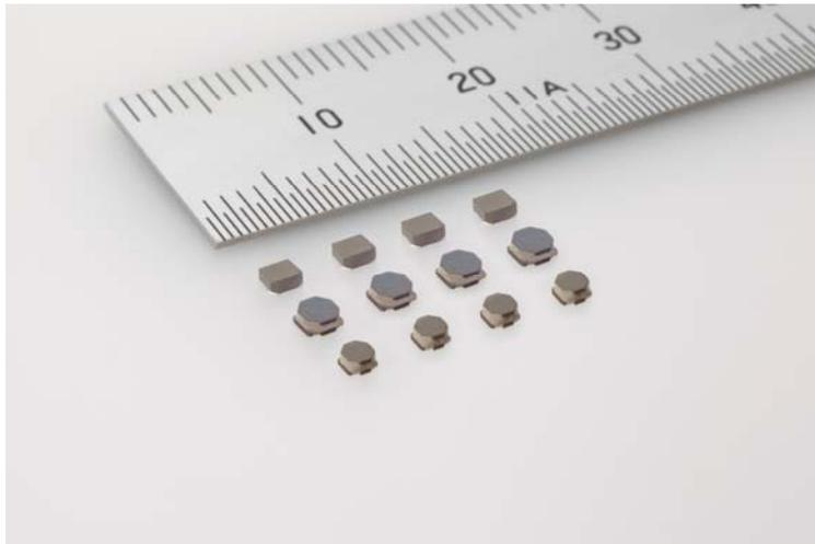
太陽誘電株式会社(代表取締役社長:綿貫 英治、本社:東京都台東区)は、メタル系パワーインダクタ「MCOIL™(エムコイル)」の薄型品として、薄さ 1.0mm を実現した 1.6mm 角メタルコア SMD パワーインダクタ「MDKK1616」(1.64x1.64x1.0mm)、2.0mm 角メタルコア SMD パワーインダクタ「MDKK2020」(2.0x2.0x1.0mm)、2016 サイズメタルコア巻線チップパワーインダクタ「MAKK2016」(2.0x1.6x1.0mm、いずれも高さは最大値)の量産を開始します。
