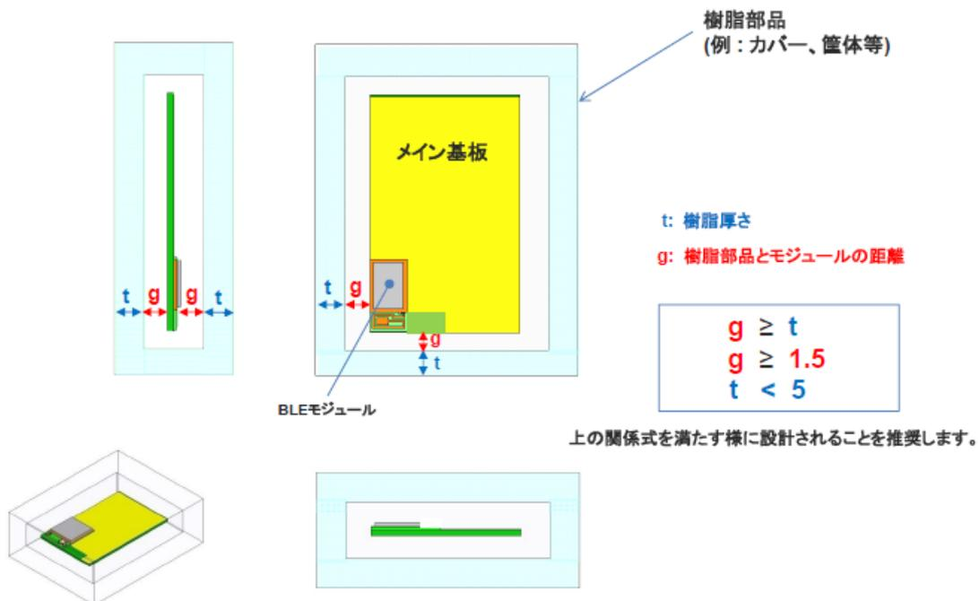
・BLEモジュールアンテナ部へのモールドは避けてください。
