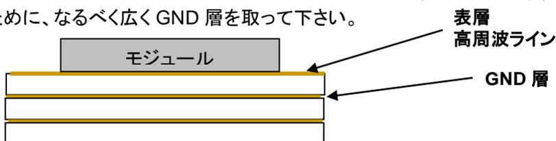
各層のGNDパターンは、多くのビアで内層のGND層に接続して下さい。
