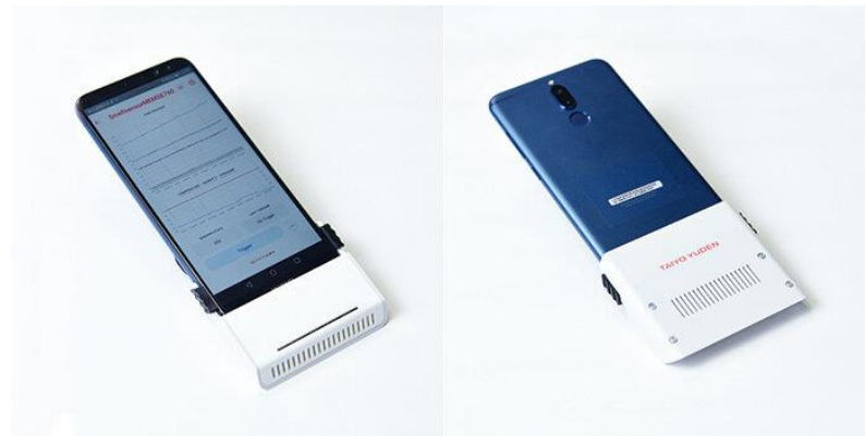
▲太阳诱电正在研发的“气味传感器”MEMS半导体型样本与智能手机相连，实时将周围的气味数据化
