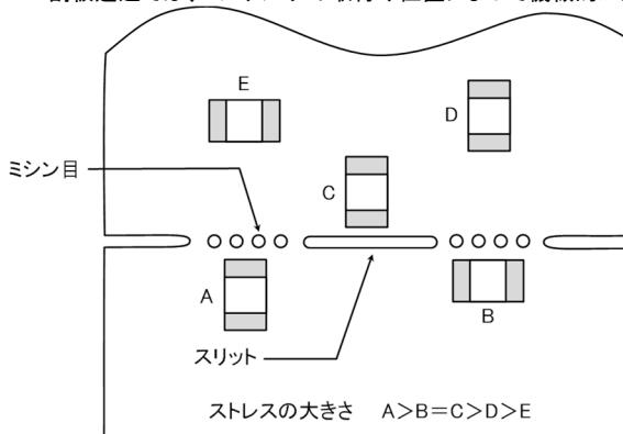
1-3. 基板分割時に、コンデンサが受ける機械的ストレスの大きさは、 $\text{ラッシュバック} < \text{スリット} < \text{V溝} < \text{ミシン目}$ の順になりますので、コンデンサの配置と同時に分割方法も考慮して下さい。
