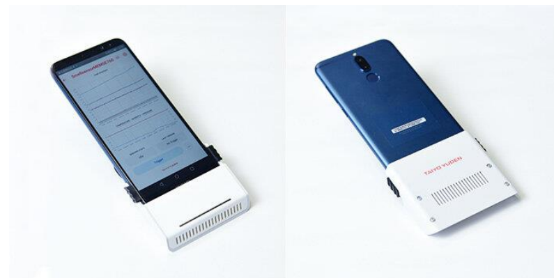
▲開発中の「においセンサ」MEMS半導体型プロトタイプ。スマホと連結し、周囲のにおいをリアルタイムでデータ化する。
