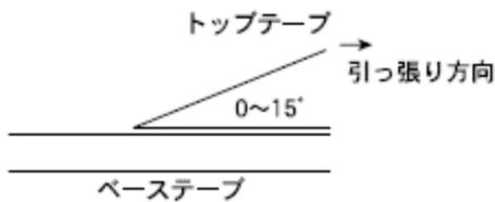
トップテープのはがし力は、下図矢印方向にて 0.1~1.0N(8mm 幅) / 0.1~1.3N(12mm 幅)となります。
