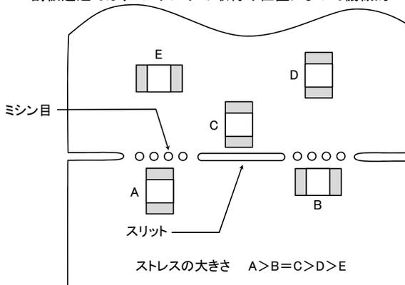
1-3. 基板分割時に、コンデンサが受ける機械的ストレスの大きさは、プッシュバック<スリット<V溝<ミシン目の順になりますので、コンデンサの配置と同時に分割方法も考慮して下さい。
